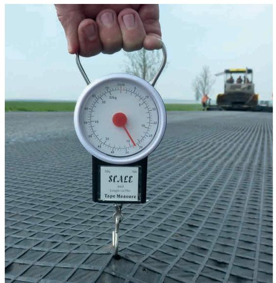
Abb. 8: Zugfestigkeitsprüfung
