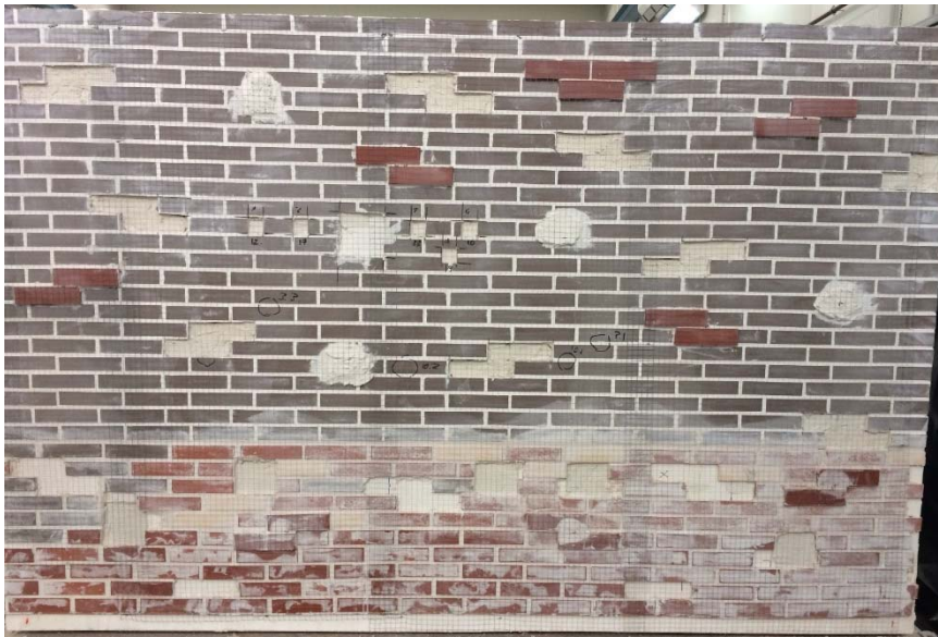
Figure 3 : Maquette avec treillis métallique : vue générale et détail au niveau d'un reliefs négatif
