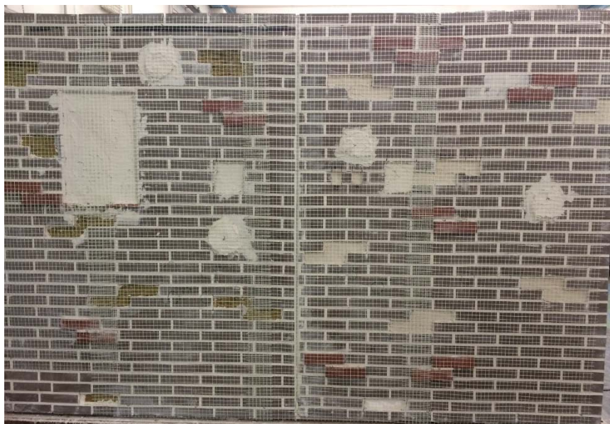
Figure 2 : Maquette avec treillis ADFORS Vertex® Reno : vue générale et détail au niveau d'un relief négatif
