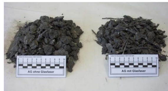
Bild 3: Asphaltgranulat ohne Glasfasern (links) und mit Glasfasern (rechts)
